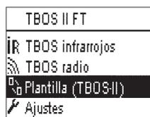
Para acceder a los menús TBOS infrarrojos y TBOS Radio, la consola de programación TBOS-II deberá estar conectada a una caja de mando TBOS o TBOS-II. Solo con esta conexión tendrá acceso a las funciones de programación de la caja.
