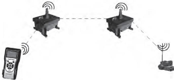
**La consola TBOS-II** es una herramienta útil para instalar una red de relés de radio, porque le permite evaluar el nivel de recepción de radio que hay entre 2 relés. Un relé de radio puede detectar otros relés de radio en su entorno. Esta operación es necesaria para configurar la red de radio e instalar nuevos relés.
